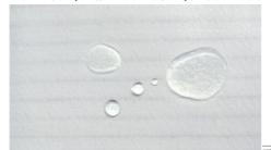
三防针刺过滤毡的三防即为"防水、防油、防静电",即在防静电针刺毡的基础上
