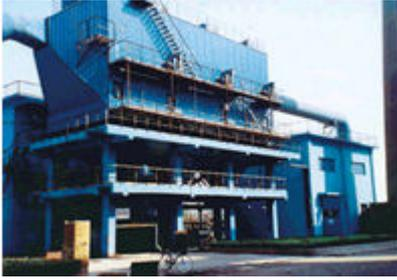
• 烘干机专用高压静电除尘器是专为水泥厂回转式烘干机配套的高效除尘器。
