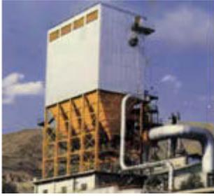
JHF 型脉动反吹扁袋除尘器适应范围广泛,行业含尘气体的净化均可使用,电弧
